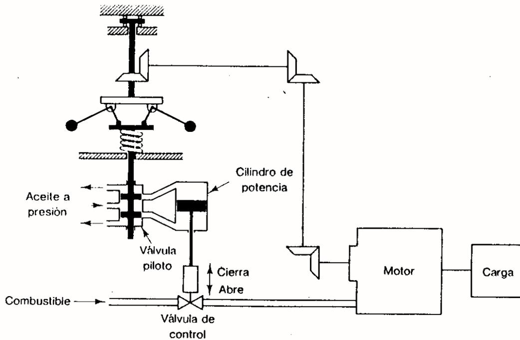
locidad deseada y la real es la señal de error. La señal actuante es la señal de control (la cantidad de combustible) a ser aplicada a la planta (motor). La perturbación es la entrada externa que puede alterar la variable controlada. Un cambio inesperado en la carga, es una perturbación.
