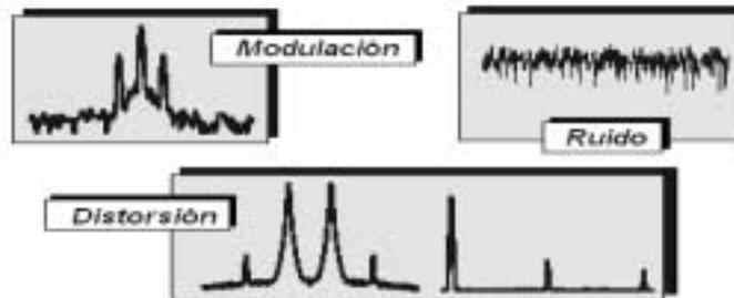
La representación de señales mediante este instrumento, nos presentará bastones con un bastón principal de mayor amplitud para la componente fundamental, y bastones a la derecha de ella, correspondientes a las armónicas.
