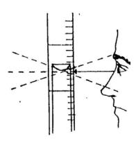
Además existe otro factor que hay que tener en cuenta para obtener una medida más exacta. La posición de sus ojos con relación a la superficie libre del líquido afecta la mayor o menor exactitud de su determinación. Comprueba en el dibujo que si el observador sitúa sus ojos por encima o por debajo del menisco, la medida será errónea. Sólo se tendrá una medida exacta situando los ojos a la altura del menisco.
