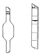
10. El ensanchamiento que presentan en su parte media las pipetas aforadas permite que el diámetro interno del resto del tubo cilíndrico sea menor que en una pipeta graduada de igual capacidad. La exactitud de la lectura del volumen de líquido es tanto mayor cuanto menor es el diámetro del tubo que contiene el líquido. Por eso, las pipetas aforadas son más exactas que las pipetas graduadas.
