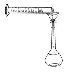
24. El matraz se llena primero con un embudo y al final mediante una pipeta, agregando el líquido gota a gota a gota que el borde inferior del menisco llegue a la marca de graduación. Recodar que, al añadir las últimas gotas de líquido hasta alcanzar el nivel adecuado, sus ojos deben hallarse al nivel de la marca de graduación del matraz aforado.
