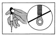
18. Las pipetas goteras calibradas del tipo usual suelen dar 20 gotas de agua destilada por cada ml, de manera que 1 gota = 0,05 ml. Sostenga la pipeta gotera en posición completamente vertical para contar las gotas. Cerciórese que no contengan burbujas de aire.
