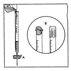
Las buretas son tubos de vidrio graduado que tienen un robinete de vidrio en el extremo inferior. Se llenan por el extremo superior con el líquido que se quiere medir. Su capacidad puede ser de 10 ml, 20 ml, 25 ml y 50 ml.
