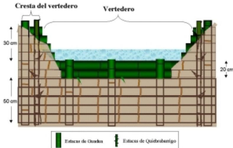
**Figura 11.** Esquema de la construcción de un trincho vivo
