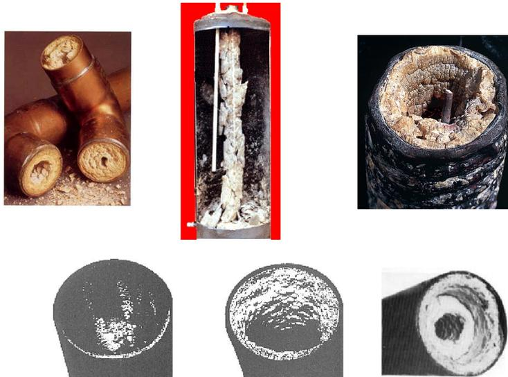
**Figura 9:** Dureza presente en el agua y consecuencias de la formación de depósitos de carbonato de calcio en accesorios y tuberías.
