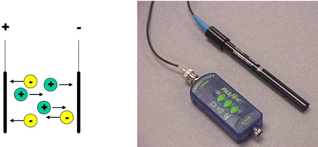
**Figura 8:** Conductímetro empleado para medición de la conductividad o concentración de sólidos disueltos en las aguas.
