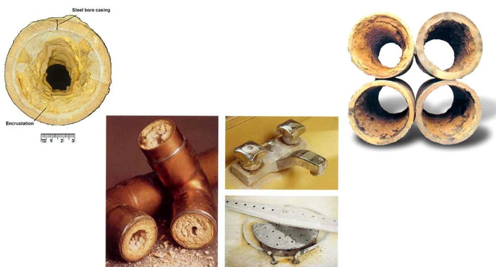
Figura 1: Problemas causados por la alta dureza del agua. Aunque el exceso de sales de calcio, magnesio y otros metales no representa daños a la salud, si causa grandes inconvenientes en el uso del agua.
