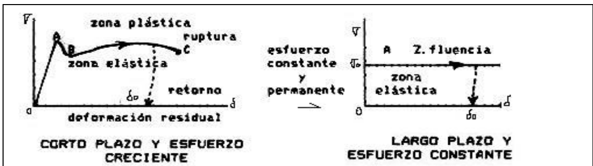
Figura 50. Carga creciente instantánea y carga constante prolongada.
