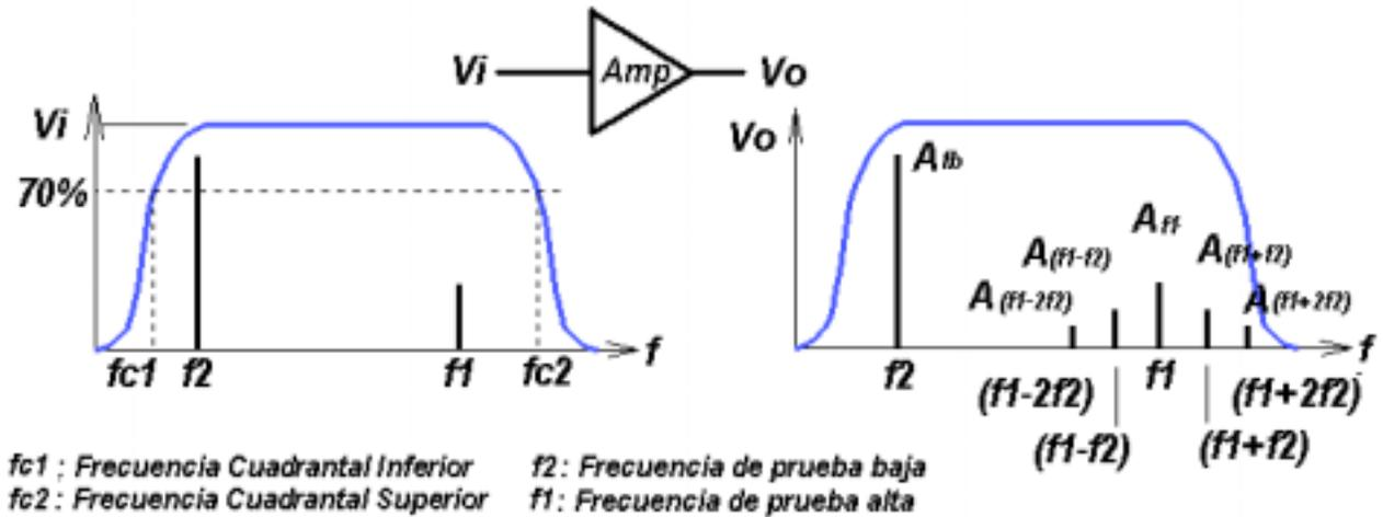
**Método CCIF:** Este método ensaya al amplificador por medio de la inyección simultánea de dos tonos de igual amplitud, pero ambos deben ser próximos entre sí y levemente menor a la frecuencia cuadrantal superior; de modo que el tono diferencia de ambos, sea mayor a la frecuencia cuadrantal inferior, o sea, caiga dentro de la banda útil, pero que sea distinto de la frecuencia de línea y de sus armónicas (50 Hz, 100 Hz, 150 Hz, etc.).
