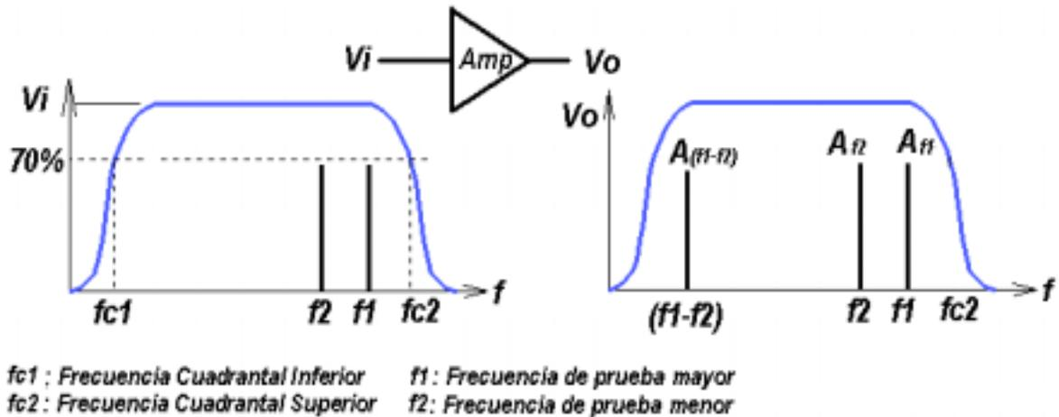
En un amplificador que distorsiona, al aplicarle un doble tono en esas condiciones, se obtienen a la salida las frecuencias originales *f1* y *f2*, las componentes armónicas de ellas *nf1* y *nf2* (dónde n = 1,2,3,...) si el amplificador es capaz de reproducirlos, y además los productos de intermodulación *f1-f2*, *f1+f2*, *nf1+ nf2*, la frecuencia de línea y las frecuencias de intermodulación entre la frecuencia de línea y las frecuencias de entrada.
