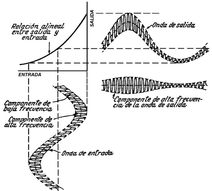
La salida se observa con un Analizador de Espectro sintonizado en la banda de audio. Si el amplificador es lineal dentro de la banda de audio especificada, la salida será igual a la de entrada (con la amplificación correspondiente), o sea sin distorsión.
