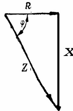
Triángulo de resistencias
