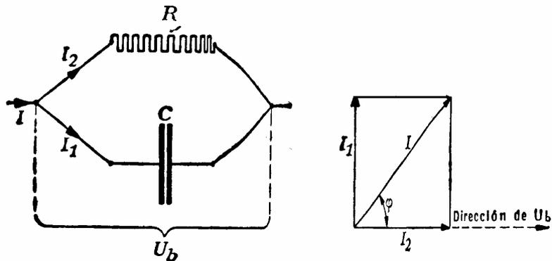
Resistencia y condensador en paralelo
