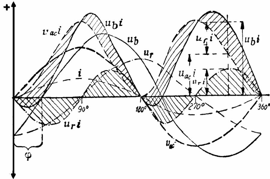
Fig 5 Curvas de potencia correspondientes a la conexión de la figura 3
