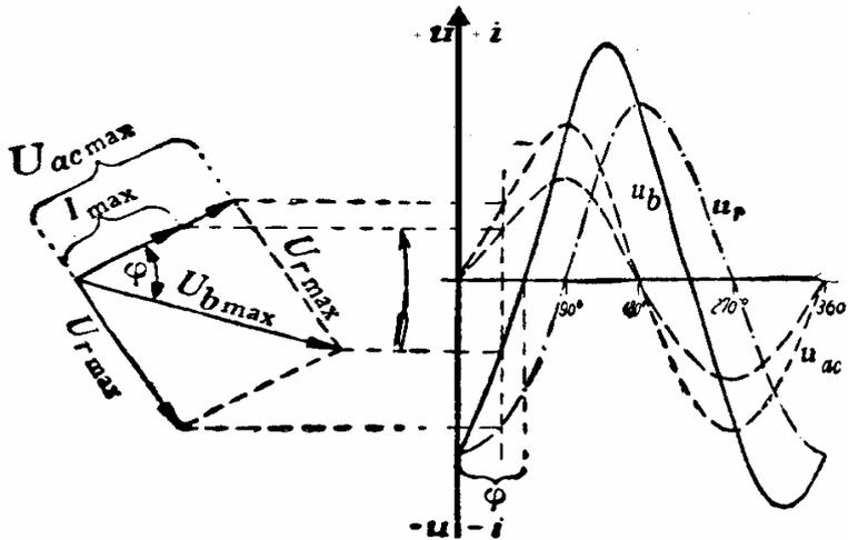
Diagrama vectorial y curvas para la conexión de la figura 1
