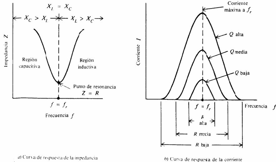
Fig. 2 Características del circuito serie RLC en resonancia
