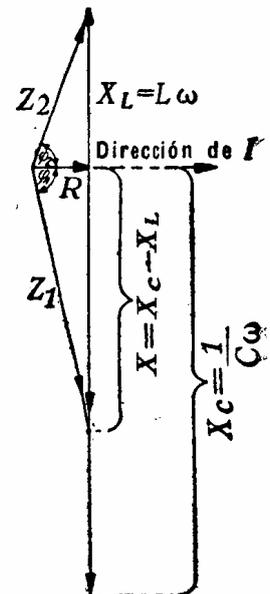
Triángulos de resistencias.
