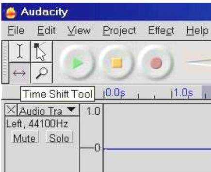
Mit dem „Time-Shift-Tool“ kann man die einzelnen „Tracks“ seitlich verschieben, um z. B. zwei Messungen zu vergleichen und die Kurven untereinander an die gleiche „Startposition“ zu verschieben.
