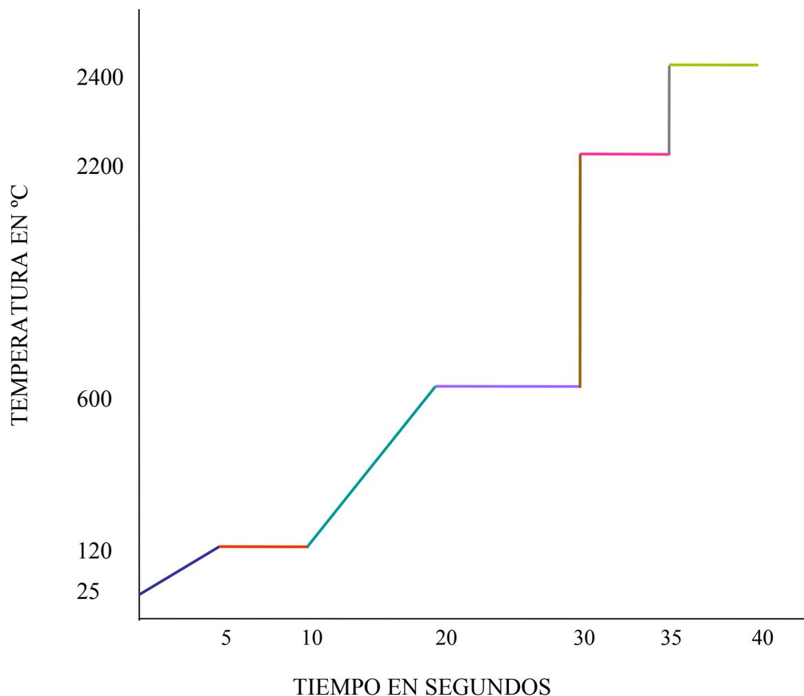
Programa de atomización en una técnica de horno de grafito: 25-120°C volatilización de solvente; 120-600°C calcinación de material orgánico; 600-2200°C atomización; 2200-2400°C limpieza del tubo de grafito.
