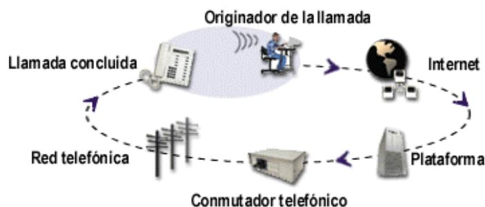
**Figura 14.** Modo de Funcionamiento de Net2Phone.
