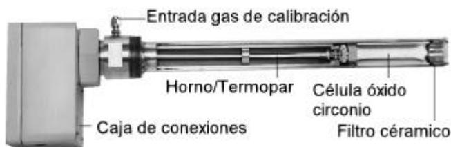
Es una sonda de inserción directa, donde la célula de óxido de circonio, está directamente en el tiro de los gases de la combustión. Este modelo está diseñado para aplicaciones donde la temperatura de los humos no exceda los 677 °C (1200 °C con tubo de enfriamiento de muestra opcional), y donde no sea necesario detectar los combustibles inquemados. La sonda está construida en acero inoxidable RA330 muy resistente a la corrosión.
