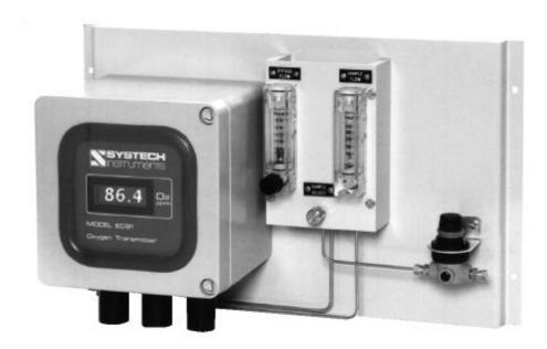
El analizador/transmisor de oxígeno modelo EC91 puede detectar niveles desde 0.01 ppm hasta altos niveles en porcentaje. Puede usarse con la mayoría de gases y atmósferas. No necesita un mantenimiento periódico como cambiar electrodos o electrolitos y se puede calibrar muy fácilmente con aire o un gas de calibración.
