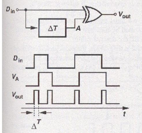
**Figure 8.3 Edge detector Circuit**
