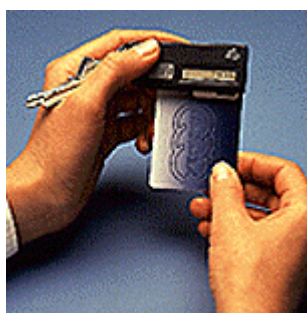
Rysunek BB Czytnik stanu karty, kwota zapisana na karcie pokazywana jest na miniaturowym wyświetlaczu.
