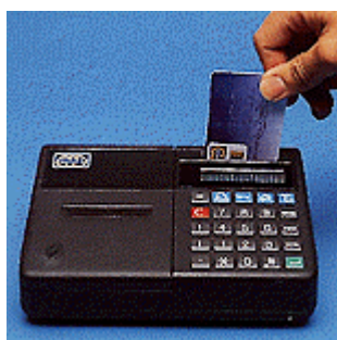
Rysunek AA Mondex POS Terminal, płatność dokonuje się poprzez wsunięcie karty do czytnika.
