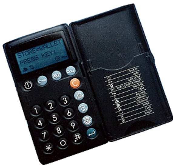
Rysunek Z Jeden z prototypowych modeli elektronicznego portfela. Oprócz klawiszy numerycznych i pomocniczych ma klawisze: zabezpieczania dostępu, wyboru waluty, przeglądu ostatnich transakcji, salda, transferu (Źródło: Mondex Corp).
