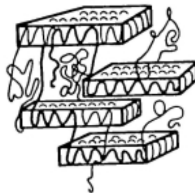
Fig. 9. Estructura laminar rodeada de material amorfo en los polímeros.
