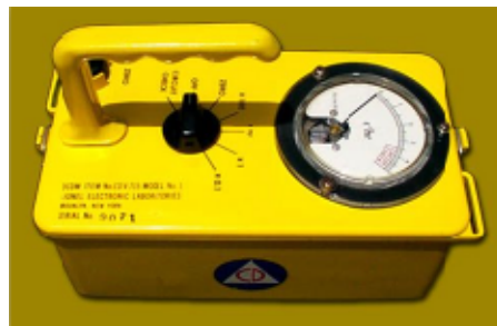
Gambar 11.8. Geiger-Muller Survey untuk mengukur laju paparan sinar-x
