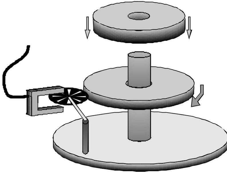
**Figura 1.** Dispositivo para estudiar colisiones de sistemas en rotación
