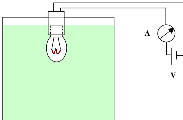
**Figura 1.** Diagrama del calorímetro para estudiar el equivalente eléctrico del calor.
