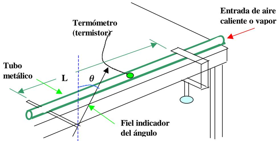
**Figura 1.** Dispositivo para estudiar la dilatación térmica de un sólido.
