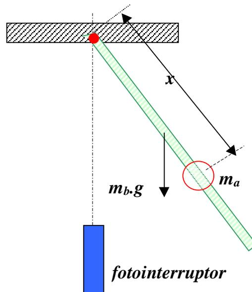
**Figura 1:** Péndulo físico con distribución de masa variable.  $m_b$  es la masa de la barra de longitud  $L_b$ .  $m_a$  es la masa adicional colocada a una distancia  $x$  del punto de suspensión.
