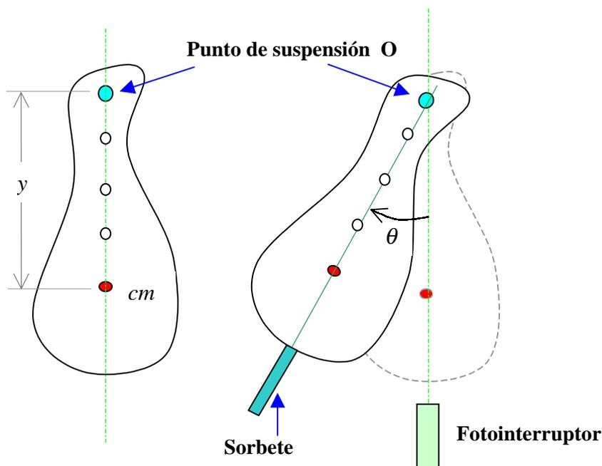
**Figura 2:** Oscilación de un cuerpo, formando un péndulo físico. Puntos de suspensión realizados en el propio cuerpo.
