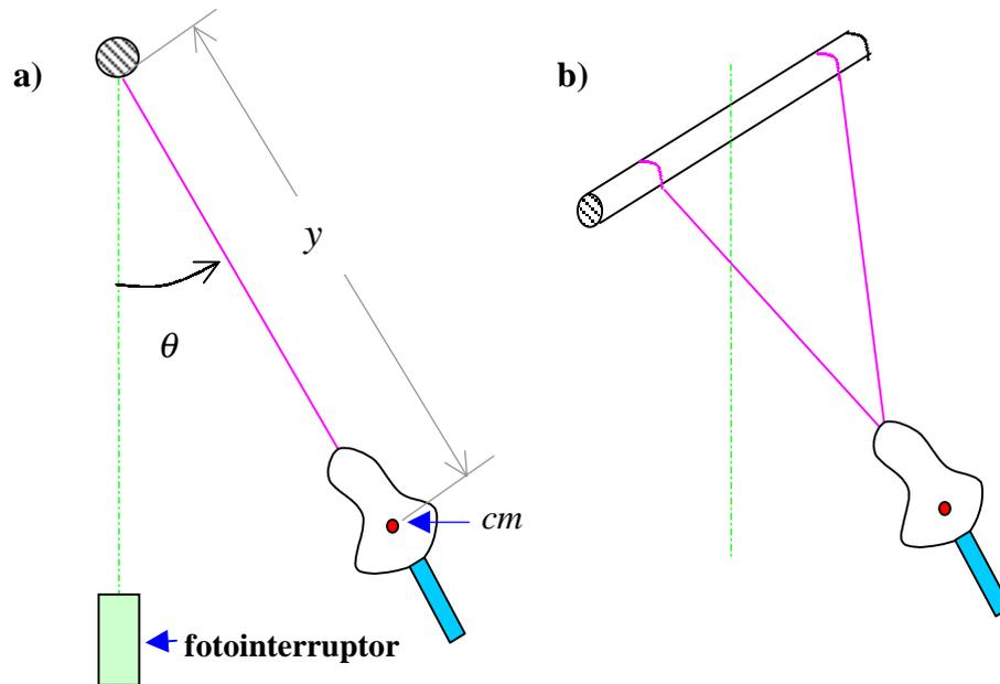
**Figura 3:** Oscilación de un cuerpo, formando un péndulo físico. Puntos de suspensión fuera del cuerpo. a) Vista de frente, b) perspectiva del sistema bifilar de suspensión.
