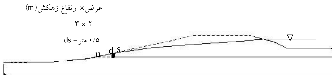
شکل (۸) - تأثیر کانال زهکش (عرض ۲ متر و ارتفاع ۳ متر) بر روی کاهش سطح تراوش (مقطع شماره ۱)
