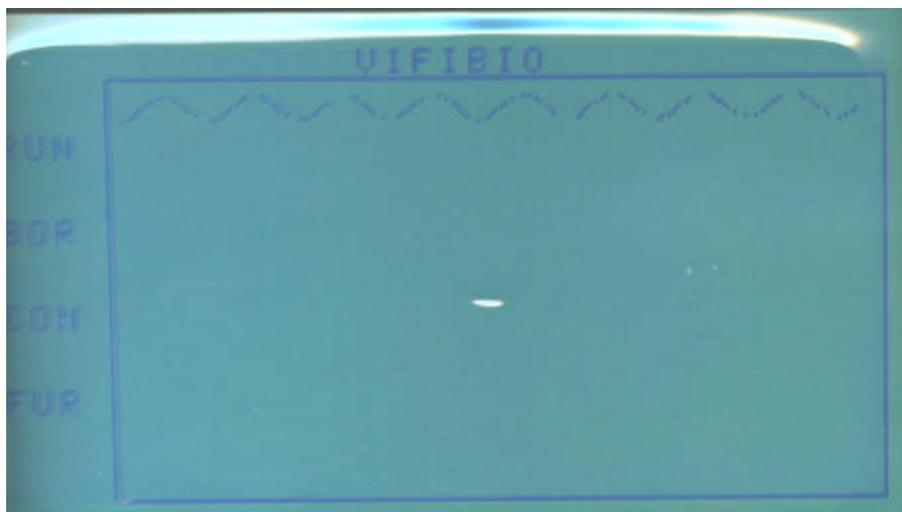
**Figura 96.** Señal senoidal de 5 Hz y 340 mV
