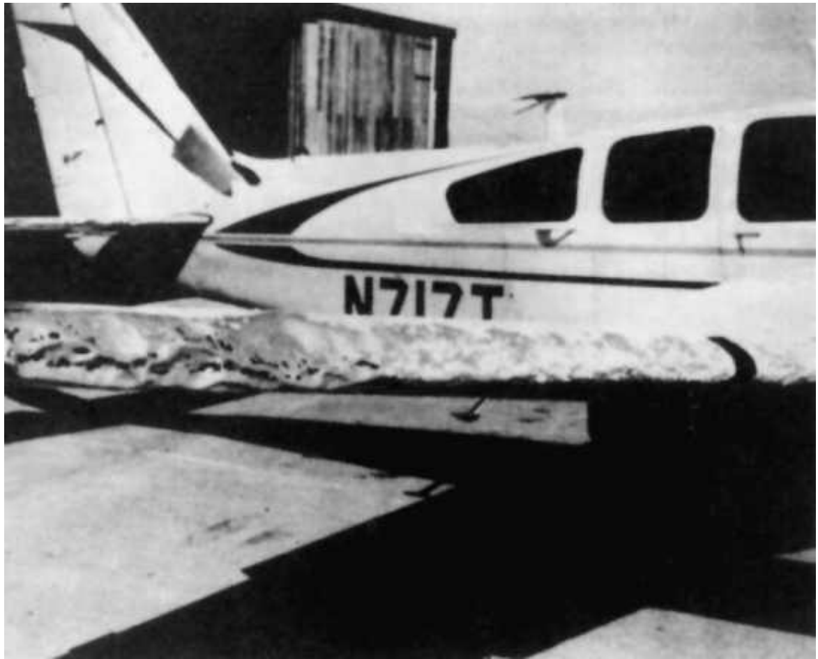
Figure 12-3 Dégâts causés par la grêle
