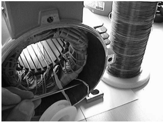
Figura 7 Armado de las espiras de medición de flujo estacionario del estator.
