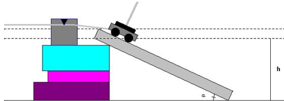
Anche in questo caso si dovrà determinare lo spazio percorso dal carrello in funzione del tempo trascorso. Dopo aver determinato la lunghezza della rotaia, misurare l'altezza  $h$  indicata in figura (serviranno in seguito!). Effettuare alcune misurazioni con altezze diverse.
